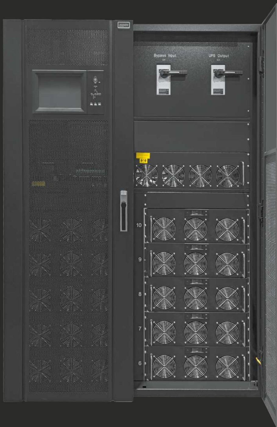
Силовой шкаф HEM500-50X (500 кВА макс. 10 слотов для силовых модулей HEPM50X )
