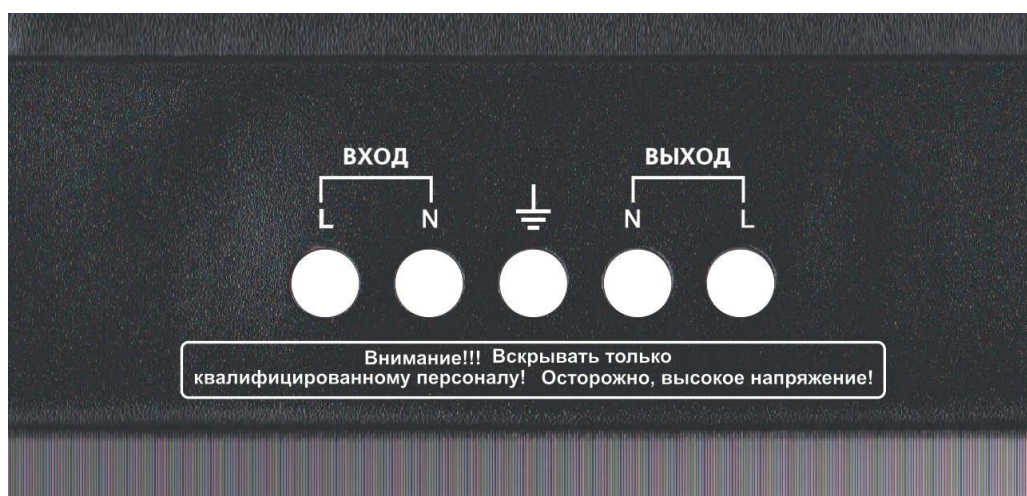
Рис.12 Подключение стабилизатора через клеммную колодку
