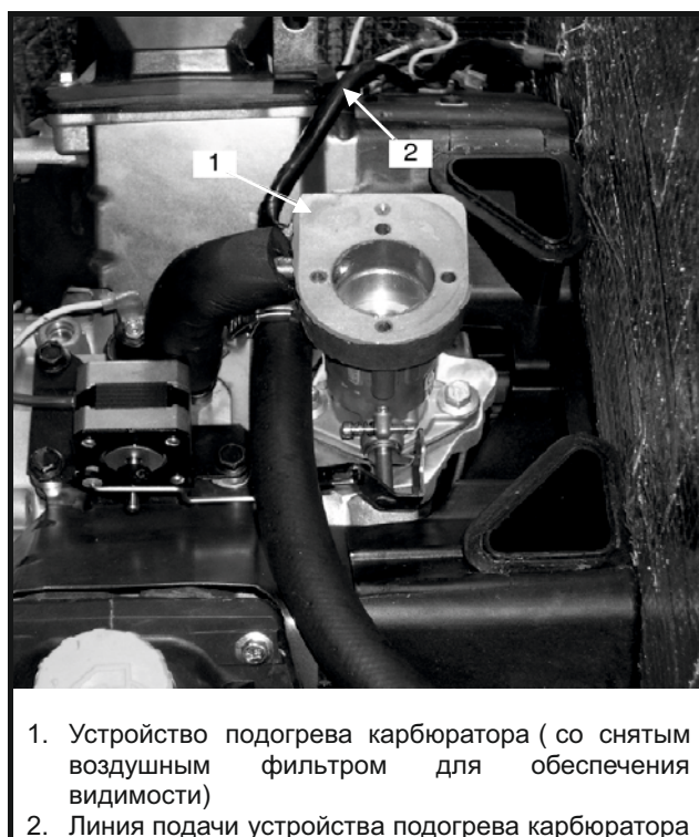
Рисунок 2.29: Устройство подогрева карбюратора, RESA 14/ RESA14T.
