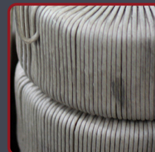
Обмотка из алюминиевого провода собственной прокатки
